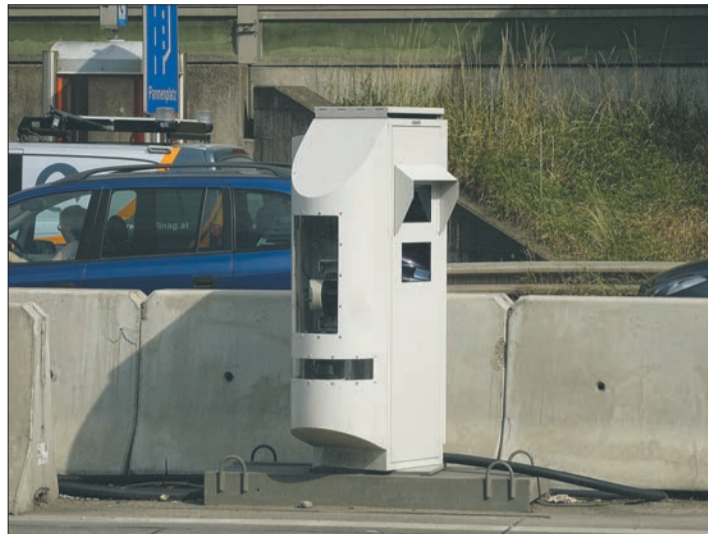
In Österreich kommt die “Section Control” an Baustellen oftmals als mobile Lösung zum Einsatz (Foto). In Deutschland wird die Technik bislang ausschließlich in Niedersachsen genutzt.
